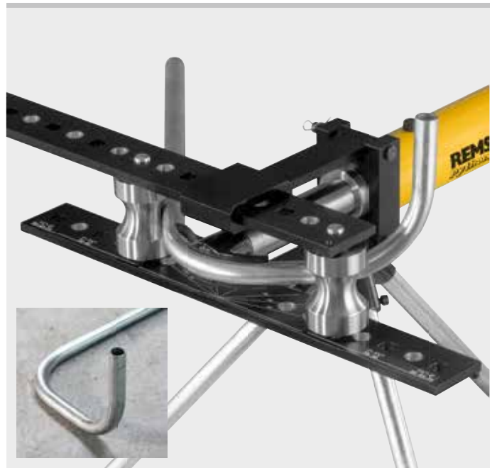
Odskok (etážový ohyb) ve více rovinách.
