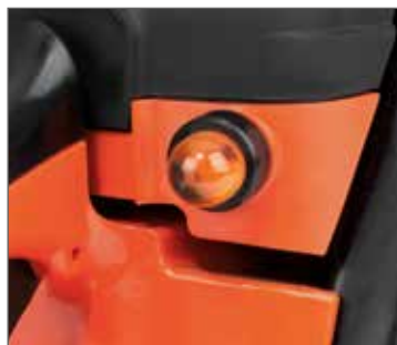
PRIMER jednoduché nastartování motoru.
